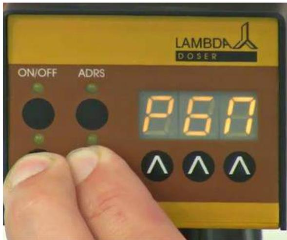
**Abb. 15:** Gleichzeitiges Drücken der REMOTE und RUN Tasten: „PGM“ erscheint auf der Anzeige.
