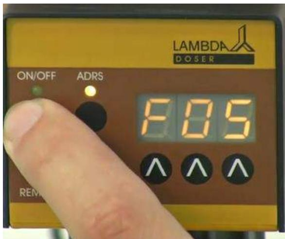
**Abb. 25:** Nachdem der Wert für die Zeit des letzten Schrittes eingegeben worden ist, wird die **ON/OFF** Taste gedrückt. Der Durchsatz (000) für den nächsten Schrittes, der nicht mehr programmiert werden soll, erscheint auf der Anzeige; z.B. „F05“.
