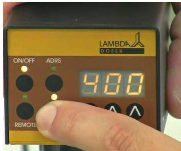
**Abb. 30:** Um das Programm zu **STARTEN**, wird die **RUN** Taste gedrückt.
