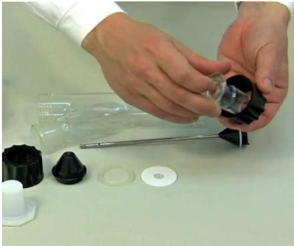
**Abb. 1:** Das Schlifftteil wird durch die Schraubkappe geschoben.
