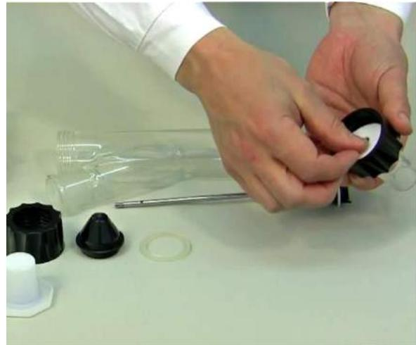
**Abb. 2:** Anschliessend wird die Teflonscheibe in die Schraubkappe und auf den Planschliff des Schlifftteils gelegt.
