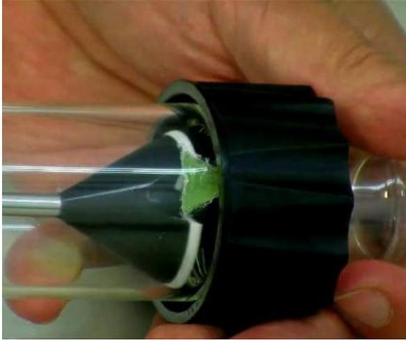
**Abb. 5:** Zuunterst im Glastubus befindet sich ein Leitteil aus Silikon. Die Öffnung des Verteilers muss dem Silikon-Leitteil zugewendet werden.
