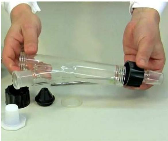
**Abb. 3:** Die Kappe wird mit dem Glastubus unten verschraubt.
